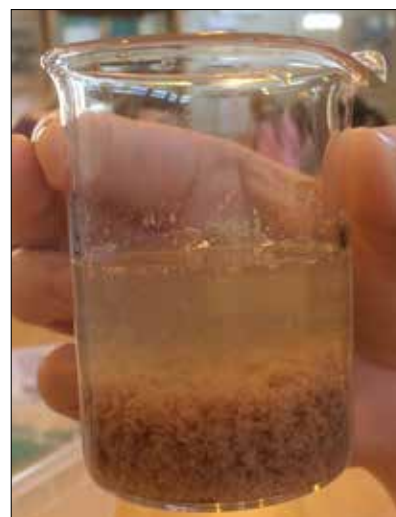
Fällningskemikalierna bildar flockar som drar till sig näringsämnen.
